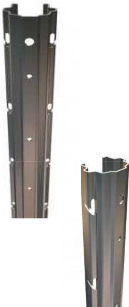
Questo palo è il palo ideale per vigneti ad alta meccanizzazione. La forma del profilo e le nervature longitudinali, abbinata alla qualità ed alla quantità (sviluppo di 135 mm) dell'acciaio utilizzato, conferiscono al nostro palo grande resistenza meccanica e flessibilità, nonché una notevole stabilità nel terreno.
